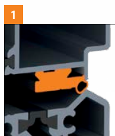
PRÍDAVNÉ TESNENIE EPDM, TESNÍ SPOJ KŘÍDLA S PRAHOM
